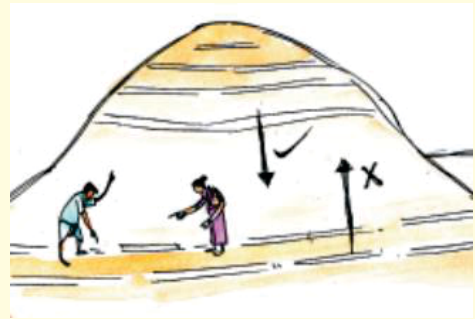
चित्र 26 :- समोच्च रेखा अर्थात कन्टूर पर ही ट्रेंच खोदे। ट्रैन्च का ऊपर का सिरा एवं कन्टूर एक ही होने चाहिये। जैसा की दोनो चित्रों में दर्शाया गया है।
